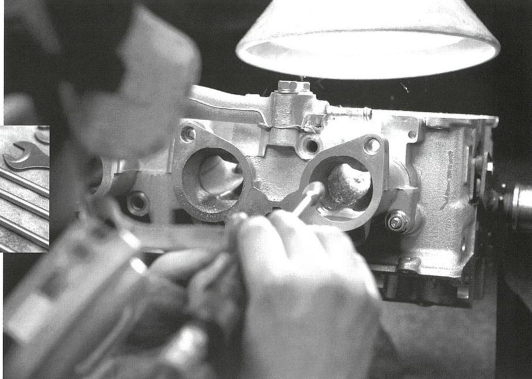
吸気&排気ともにポートの段付きをリユーターで削る。目検討なので経験が必要になりそう。
