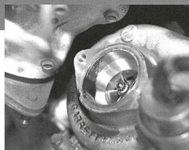
エンジンより先にタービンが寿命を迎えることが多い。オイル溜まりをチェックしてほしい。
