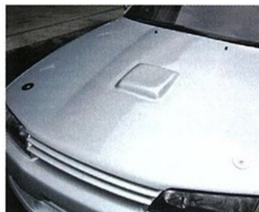
シリンダーブロックにRB30用を使っている ので、エンジンの全高が高くなる。その ため、ボンネットを開ける際に干渉す るということで、パワーバルジを設けて いるのだ。
