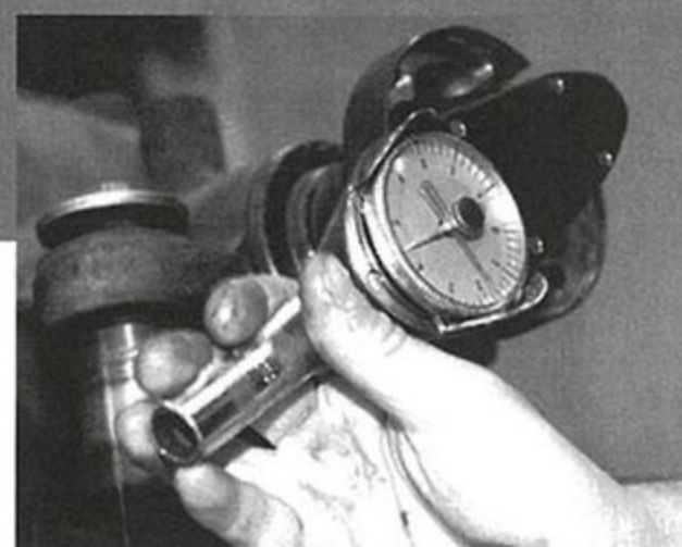
分解前に、現状でのトルクをしっかりと測定しておく。トルクの落ち具合などから走り方なども見えてくる。また次の組み方のヒントにもなる。
