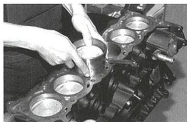
ピストン&クランクをシリンダーに挿入していく。
