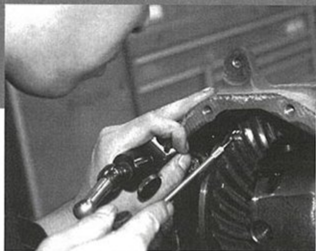
ドライブシャフト側を固定して、リングギアのガタ、いわゆるバックラッシュを測定する。大きすぎても詰まりすぎてもNG。
