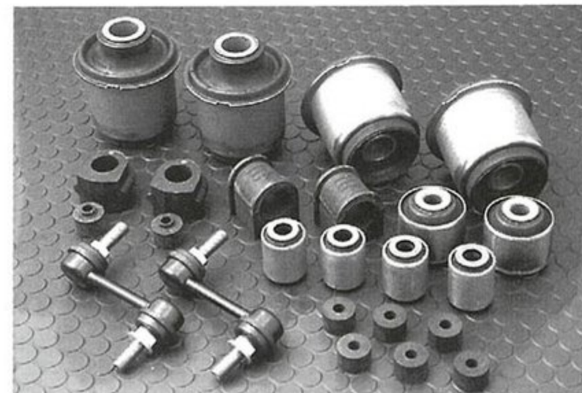
リンクごと交換するタイプのブッシュが多いが、スタビライザー端など単品で交換するタイプも意外と多い。
