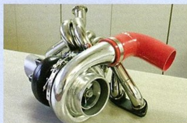
写真ではスケールがわからないだろうが、このタービンはかなり大きい。ギャレット製で対応馬力はなんと1350ps。どんなクルマに付けるのだろうか？ ビッグブロック用か？
