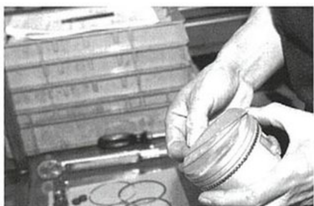
クリアランス確認後ピストンにリングをはめる
