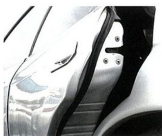
このクルマでもっとも苦労したポイントが、リ アのドア。GT-Rの幅に合わせるため、GT- Rのフェンダーを貼り付け、ドアのラインに合 わせてカット。その上で板金を行っているの だ。相当手の込んだボディチューンだ。
