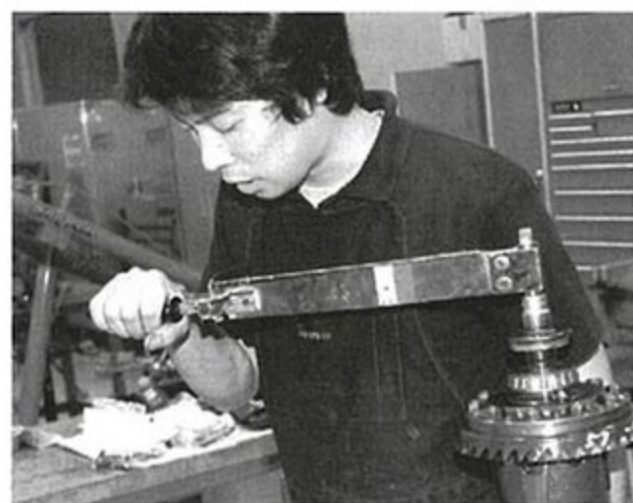
単体でのイニシャルトルクも測定する。
