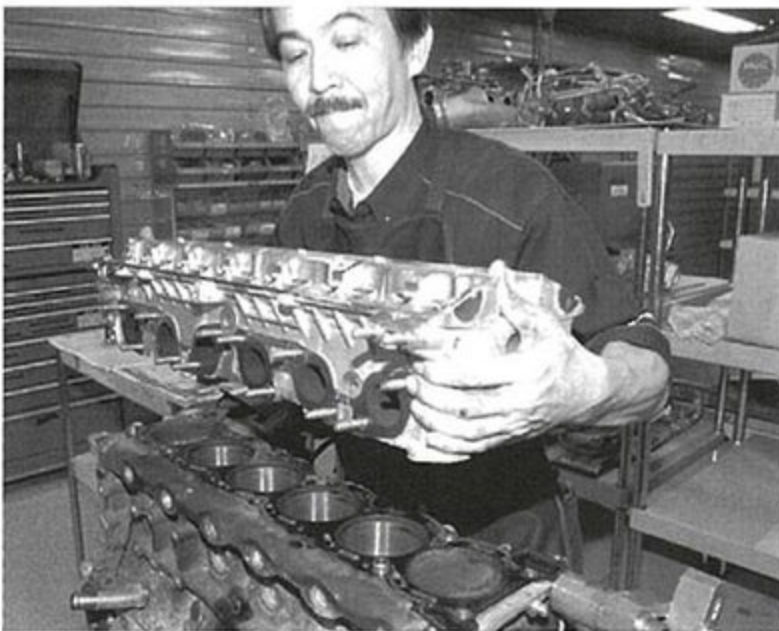
スタートボルトを抜きヘッドを降ろす。その後ヘッドは気密を測定し、さらにパーツをすべて取り外し洗浄される。
