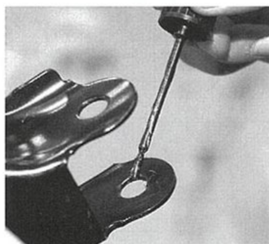
ブッシュ圧入済みのリンクはバリをしっかりと取ったうえで削れた塗装を修復してから取り付ける。
