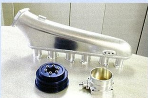
こちらは現地のメーカーである「ハイパーチューン」が製作したRB26用のサージタンクと汎用品のビッグスロットル。スロットル径はφ77〜100mmのものがある。それにしても巨大なサイズだ。また、青いブローは「ROSS」というメーカーの軽量ブローで、ジュラルミン製ながらダンパーゴムを内蔵するスグレモノ。
