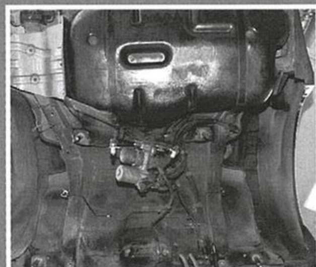
下回りのパーツをおおかた外してしまうと、ボディ側の状況も見えてくる。融雪剤を使う地域ではサビが出ているので、再塗装など施したいところ。
