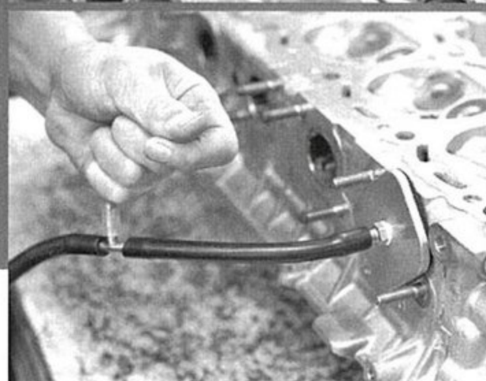
手作業による研磨材で擦り合わせた後に気密をチェックする。
