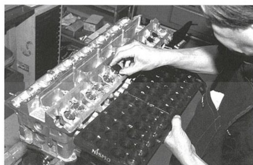
その後、バルブリフターを挿入していく。
