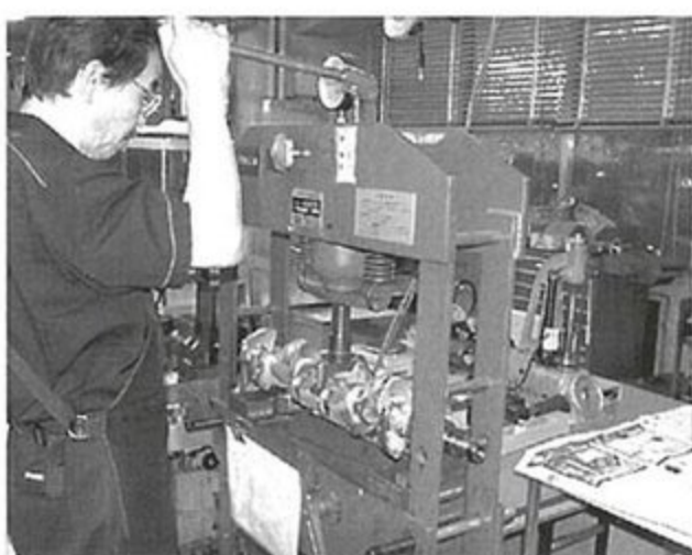
歪みを確認したら油圧プレスで徐々に修正していく。根気のいる行程だ。
