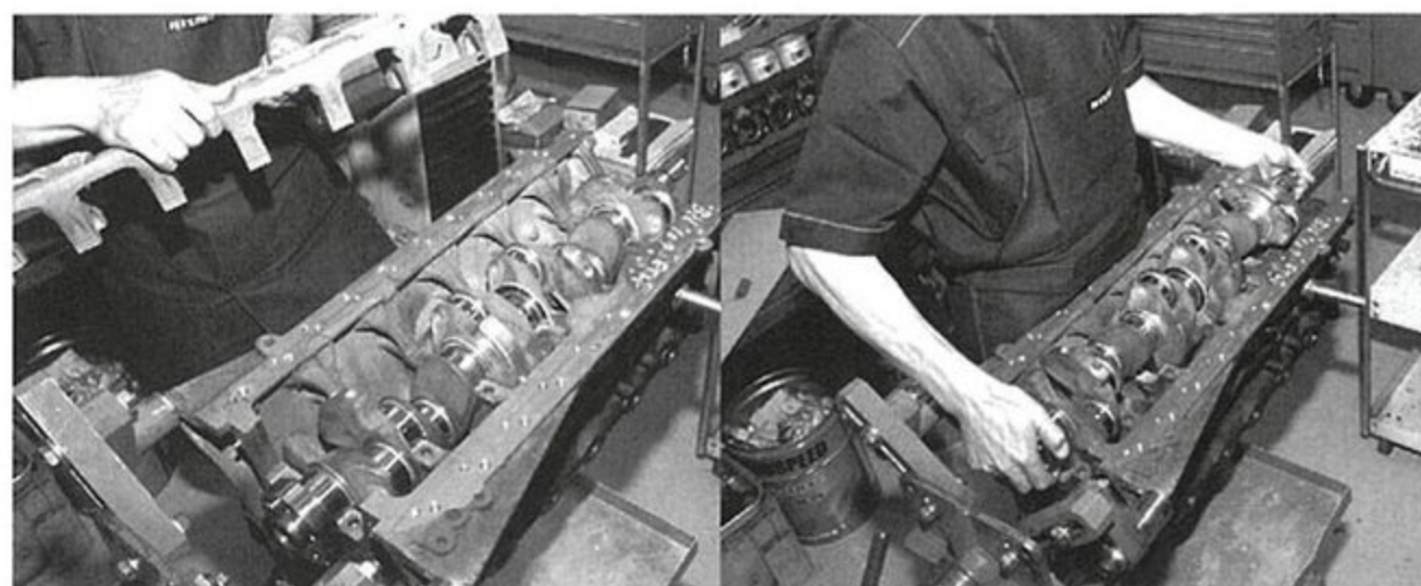
そしてマウントをブロックに装着しクランクを組み込む。
