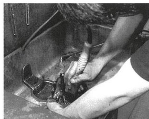
その後、再利用するパーツはすべて洗浄される。
