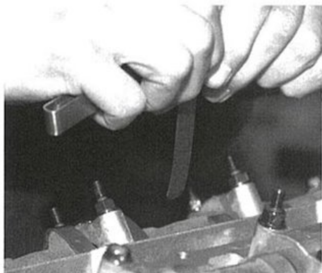
シムを交換してはシクネスゲージで測定していく。
