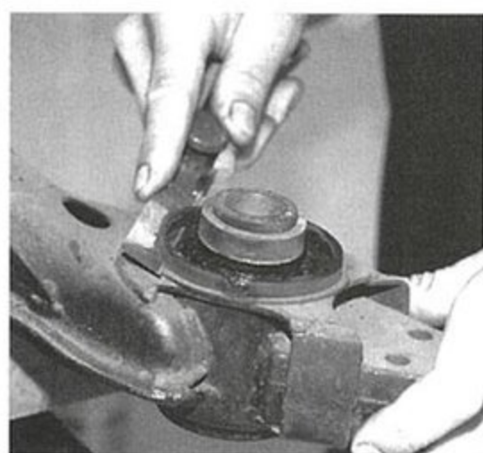
はみ出しているゴムの部分をカッターでそぎ落とす。
