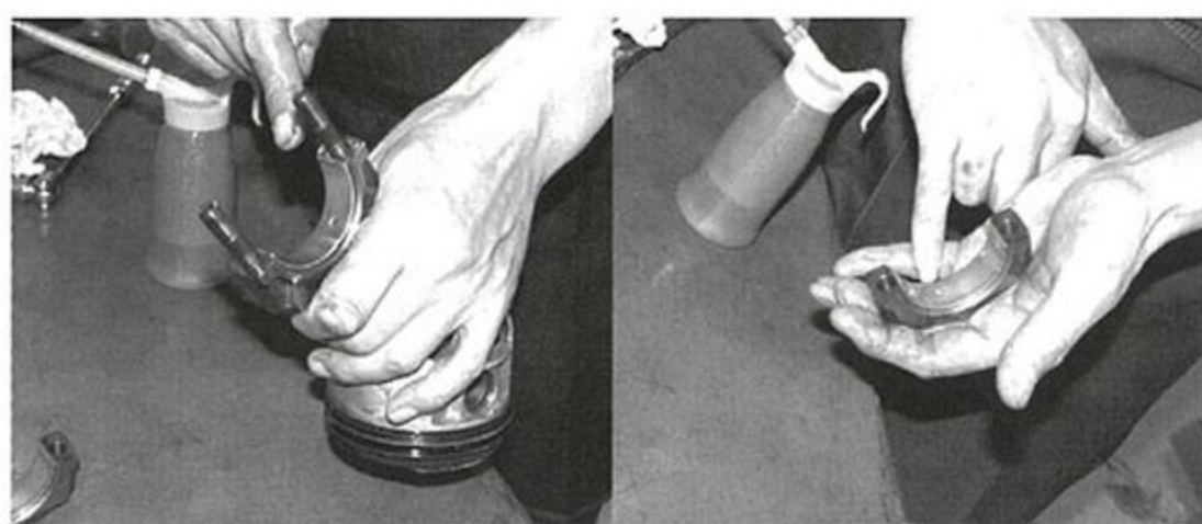
コンロッドのメタルを確認。摩耗した部分は色が違うのがわかるだろうか。
