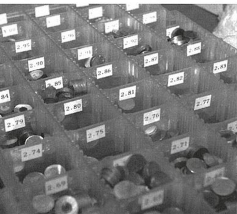
このように厚み別にシムがストックされていた。その厚み別の中でもばらつきがあるので、測定しては組み込んでいく。
