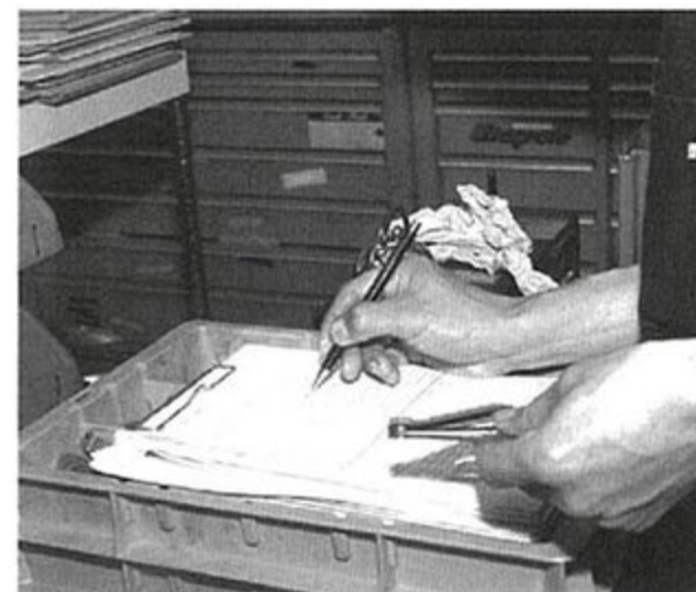
クリアランスとシムの厚みをすべて記録して、一定の幅に収める。
