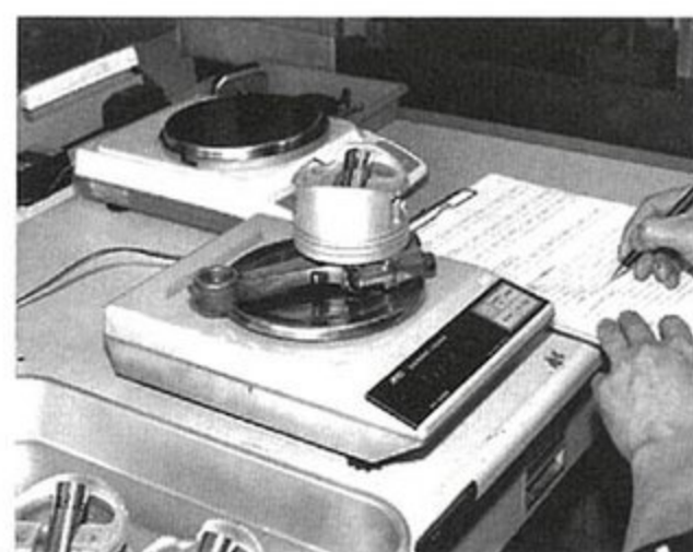
ピストンとピンはセットで計る。
