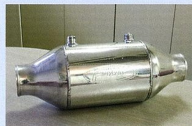
このパーツは日本では見慣れない形状だが、水冷のインタークーラーなのだ(PWRというメーカー製)。大型で円筒形ゆえにエンジンルーム内に収めるのは大変だが、水冷式なのでトランクに設置することも可能。吸入空気が軸方向に通り、周囲を水で冷やす仕組み。
