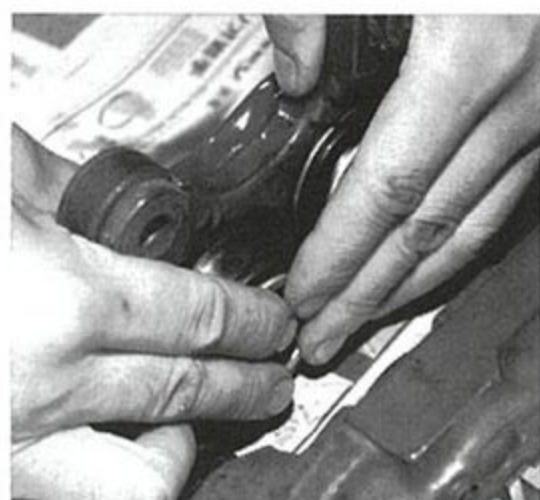
ブーツを装着後、ピストンを本体に挿入。
