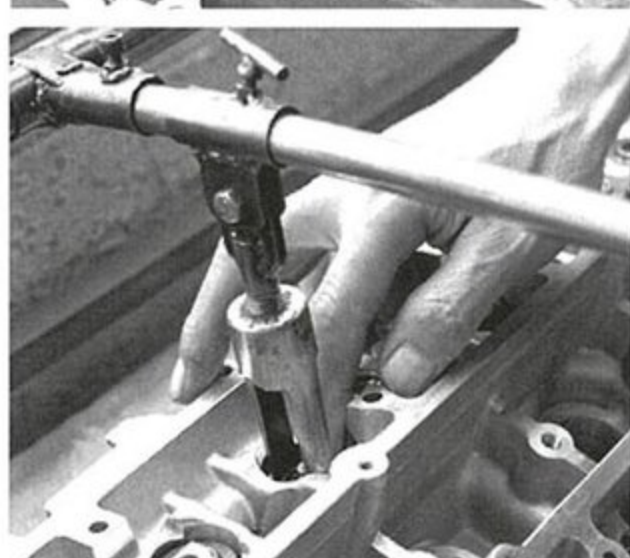
シートを専用工具で入れて、スプリング、コッターをこちら専用工具ではめ込む。
