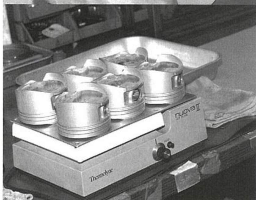
ピストンをヒーターで温めて膨張させてからピンを入れる。
