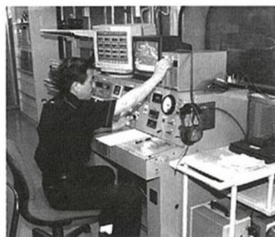
ニスモではエンジンベンチに乗せてパワーチェックを行い、さらに慣らし運転なども行うとのこと。
