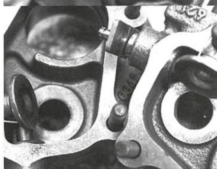
クランクを回し、バルブタイミングが適正かどうかをチェックする。
