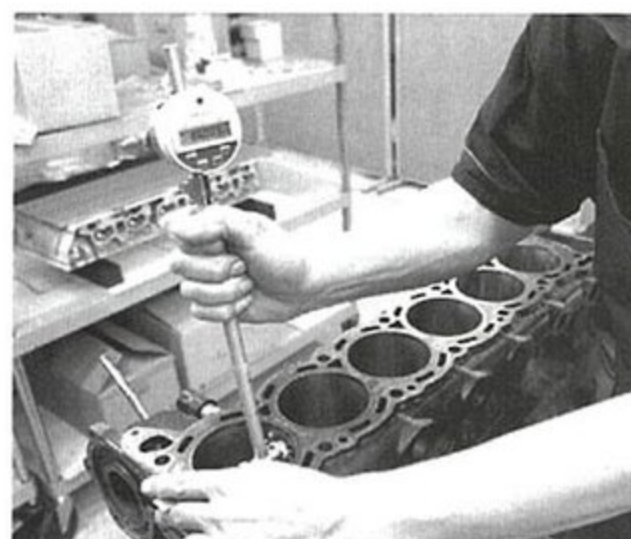
残ったガスケットやカーボンを落とし、内径を測定し摩耗度合いをチェックする。
