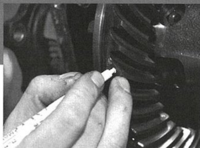
歯当たりも事前にチェック。専用のマーカで塗料を付けた後に回転させて歯の当たっている部分をチェック。
