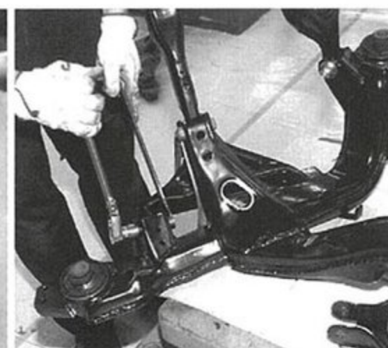
ブッシュ圧入済みのリンクはバリをしっかりと取ったうえで削れた塗装を修復してから取り付ける。
