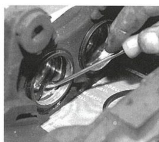
本体に傷を付けないようにブーツを取り出す。
