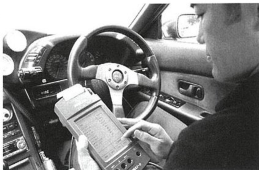
電装品など劣化が目で見えない部分はこの診断による方法以外にチェックできない。
