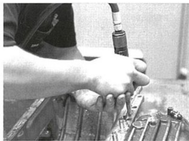
オイルパンも腰下から外し洗浄。その後溝の中の樹脂製のガスケットを削り取る。
