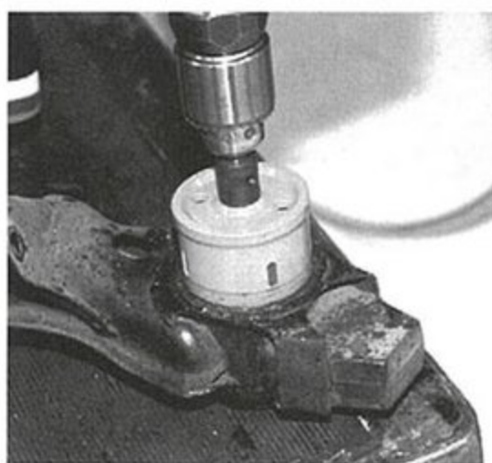
ホールソーでスチールケースの縁を切り落とす。
