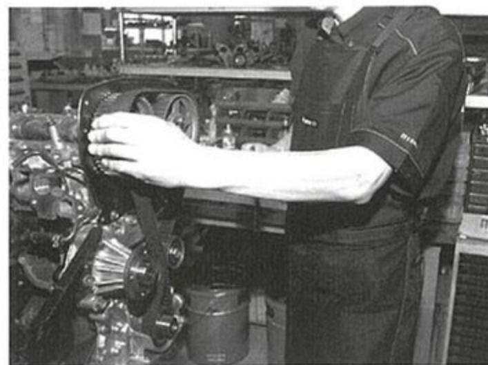
クランクプーリーも装着し、タイミングベルトを張る。
