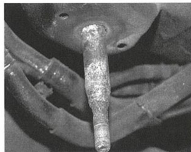
メンバーを降ろすと、ボディ側のボルトが出てくる。この車両はかなりサビが進行していた。
