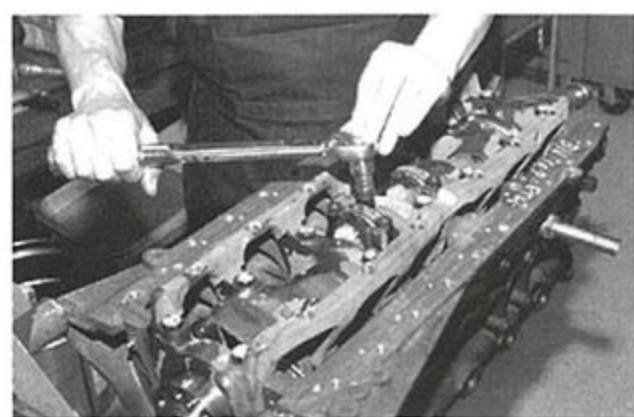
コンロッドをクランクに固定し、クランクも固定。
