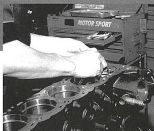
ピストンリングをシリンダー内に入れて、合い口のクリアランスをチェックする。
